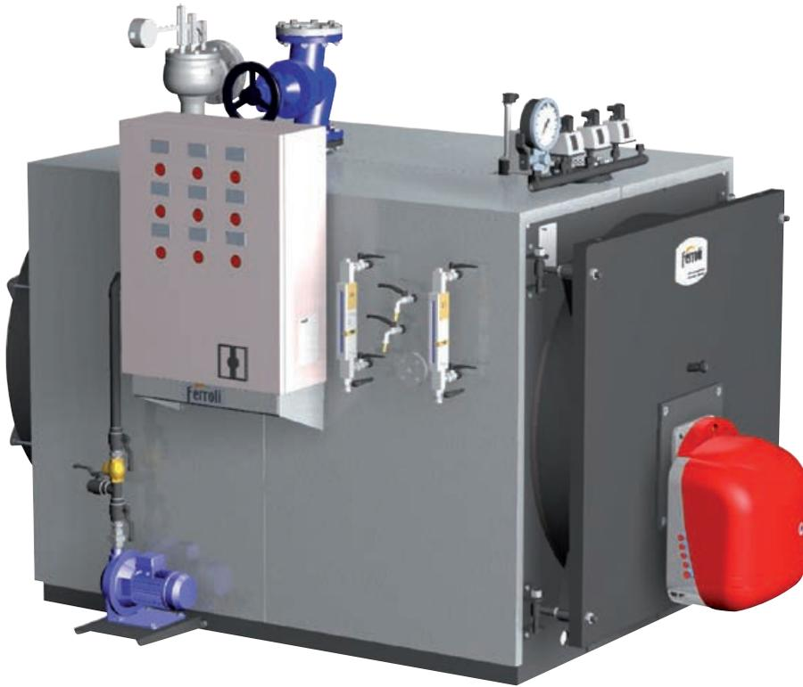
Generatore di vapore saturo a bassa pressione ad inversione di fiamma, monoblocco, in acciaio a combustione pressurizzata ed elevata efficienza energetica. Predisposto per funzionare in abbinamento ad un bruciatore ad aria soffiata a combustibile liquido o gassoso. Focolare ad inversione di fiamma e camera di combustione con fondo bagnato e dimensionata in modo tale da assicurare bassi carichi termici.
